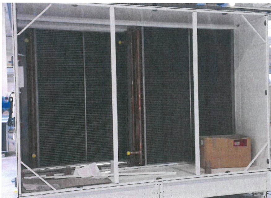
Batteries doubles avec piquage batterie en centrale pour montage de panoplie en centrale
