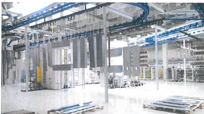
Ligne de poudrage automatisée intégrée dans l'unité de production
